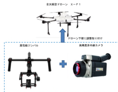
図-2 空中探査システム概要
