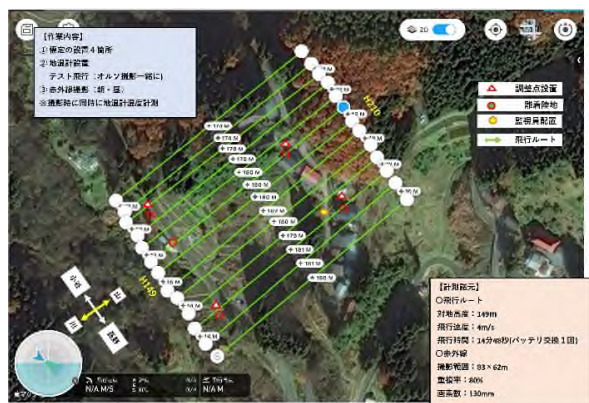
図-3 空中地温探査 飛行計画図
